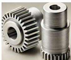
くずれやすい 焼結前の部品
