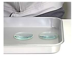
薄型トレイのため、たわみが生じる
